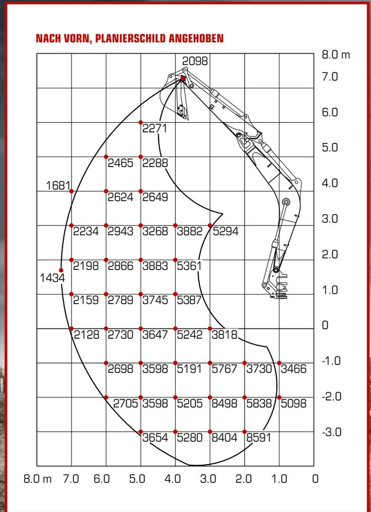
Die Hublasten in den Grafiken betragen bis zu 87% der hydraulischen Hublast bzw. bis zu 75% der Kipplast. Die Werte sind in Kilogramm angegeben – ohne Powertilt. Technische Änderungen vorbehalten.
